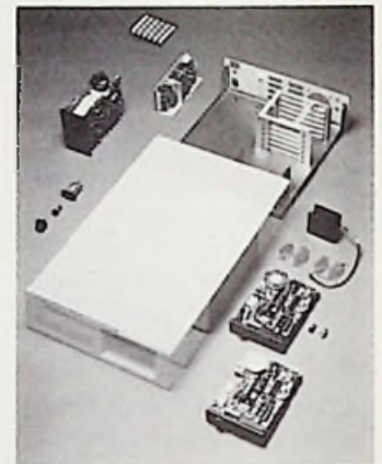
Bild 1: Bestandteile des Personalcomputer-Bausatzes (Feltron-Zeissler-Pressbild)
