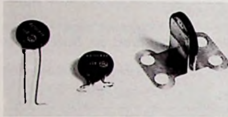
Bild 5: Anschlußgestaltung von Varistoren. links: zu lange Anschlüsse handelsüblicher Typen, mitte: gekürzte Anschlüsse (Crimped Leads) für gedruckte Schaltungen, rechts: Hochstromanschlüsse.
