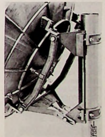
Bild 2: Konstruktion und Justiereinrichtungen der neuen Parabolantennen (FTE-Pressbild)
