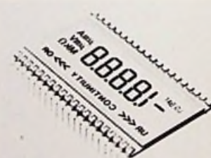
Bild 1: Entspiegelte LCD-Anzeige (Hitachi-Pressebild)
