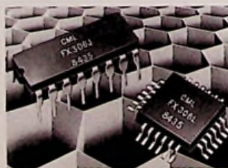
Bild 1: Einchip-LSI-Filter in Keramik-DIL- und in Kunststoff-Flatpackgehäuse (Ginsbury-Pressebild)
