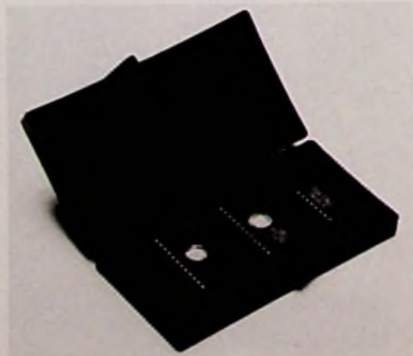
Bild 11: Besonders Mos-ICs sollten in leitfähigem Schaumstoff verpackt werden (3 M-Pressbild)
